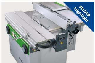
Possibilité d'adaptation ultra rapide du rabotage au sciage ou au fraisage et inversement
