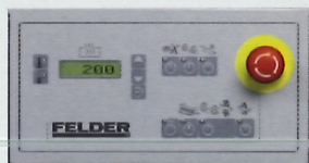
Bedienpult mit LCD-Anzeige und Tastenfeld
