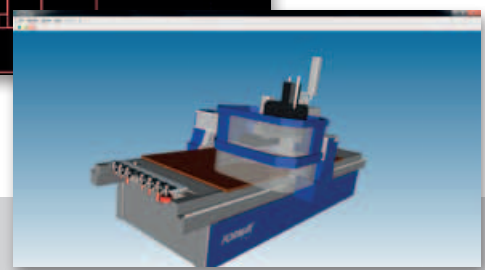
3D Simulator Optional, exakte Darstellung Ihrer Maschine als 3D Modell inkl. Kollisionskontrolle
