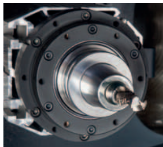
007 Frässpindel 12 kW (S6) HSK F63, 24.000 U/min
