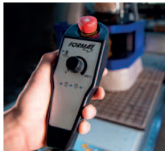
C18 Handterminal zur Fernsteuerung der Achsen:
