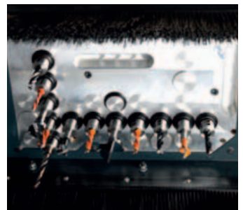
C190 Bohrkopf DH 12; mit 12 vertikalen Spindeln
