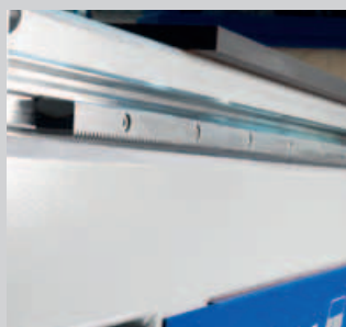
Portalbauweise mit „Gantry“-Antrieb
