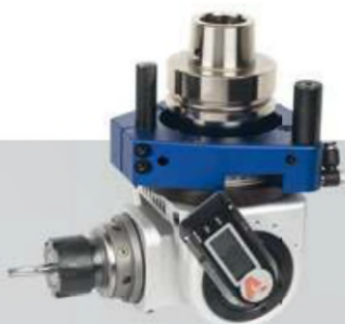
HSK F63 Schwenkaggregat, digital mit ET Schnittstelle für Bohr- Fräs- oder Sägewerkzeug, max. Ø 180 mm, Winkeleinstellung und Schnellverschluss Best.-Nr. 300-24-023
