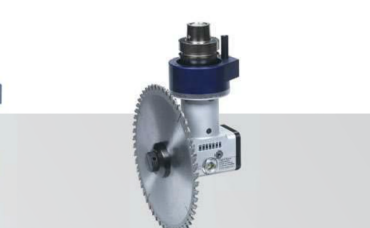
HSK F63 Einfachwinkelkopf zur Aufnahme eines verschraubten Sägeblattes mit einem WELDON Ausgang, max. Ø 180 mm Best.-Nr. 300-24-002 max. Ø 240 mm Best.-Nr. 300-24-003 max. Ø 300 mm Best.-Nr. 300-24-007
