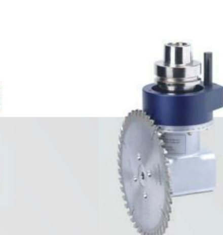
HSK F63 Einfachwinkelkopf zur Aufnahme eines verschraubten Sägeblattes mit einem WELDON Ausgang, max. Ø 180 mm Best.-Nr. 300-24-002 max. Ø 240 mm Best.-Nr. 300-24-003 max. Ø 300 mm Best.-Nr. 300-24-007
