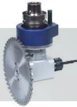
HSK F63 Zweifachwinkelkopf mit 1 Ausgang für Bohr- Fräswerkzeug ER 25 und 1 Ausgang WELDON mit verschraubtem Sägeblatt, max. Ø 180 mm Best.-Nr. 300-24-012
