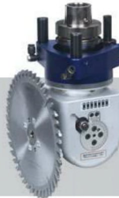
HSK F63 Schwenkaggregat mit einem WELDON Ausgang für Sägewerkzeug max. Ø 240 mm Best.-Nr. 300-24-020
