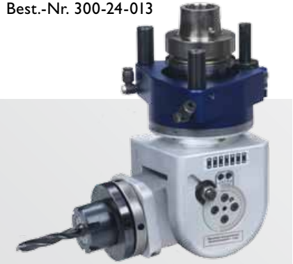
11 HSK F63 Schwenkaggregat mit 1 Ausgang ER 25 für Bohr-, Fräs- oder Sägewerkzeug max. Ø 240 mm Best.-Nr. 300-24-013
