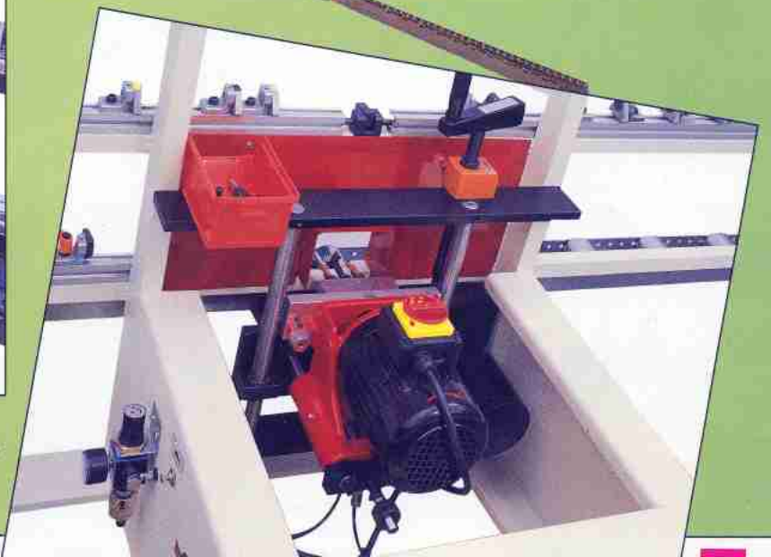
Abbildung zeigt Profi standardmäßig mit integrierter Späneabsaugung, ohne Höhenabstufung ▷
