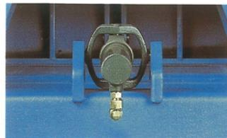
Hydraulikzylinder „kardanisch“ befestigt um Querkräfte auf die Kolbenmanschetten zu vermeiden
