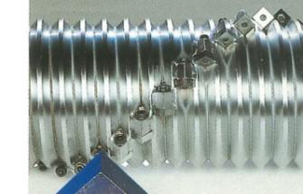
Die bewährten Schneidwerkzeuge sind 4 x drehbar, äußerst wirtschaftlich und aus hochwertigem Spezialstahl – deshalb lange Standzeiten. Sie sind leicht und schnell austauschbar – kein Aufscheißen notwendig.
