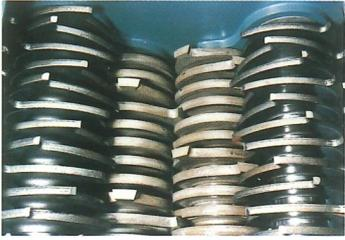
Hohe Durchsatzleistung durch 4 Messerwellen. Unempfindlich gegen Fremdkörper.
