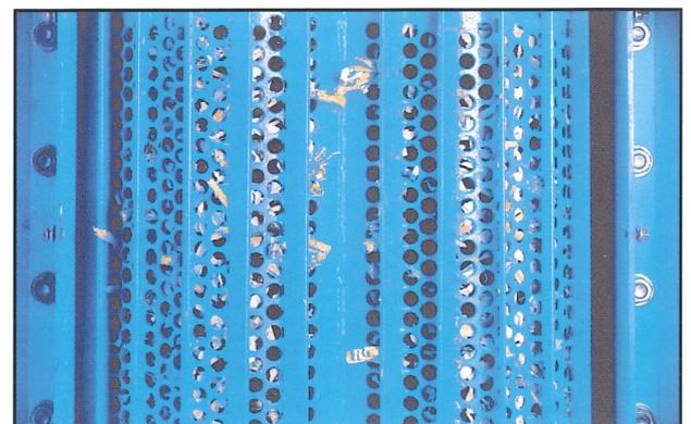
Durch Anordnung von **Nachbrechern** unter dem Lochsieb werden lange Späne vermieden.
