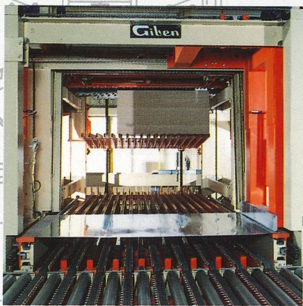
Mitte, von oben nach unten: Tunnelabstapelung auf einem Spindel-Hubtisch bis zur Übergabe des fertigen Stapels mit unterer und oberer Schonplatte auf die Rollenbahn zur Abbindestation.
