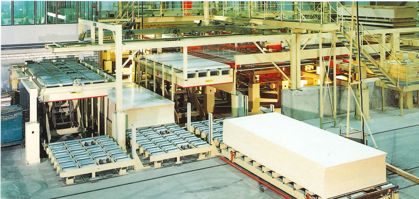
Stapelbeschickung per Beschickungswagen und drei Hubtischstationen
