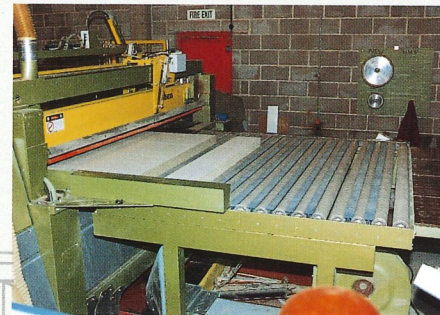
Handabstapelung mit Rollenbahn-Pufferzone zwischen Säge und Luftkissentischen
