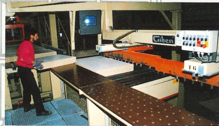
Handabstapelung mit Luftkissentischen in U-Form
