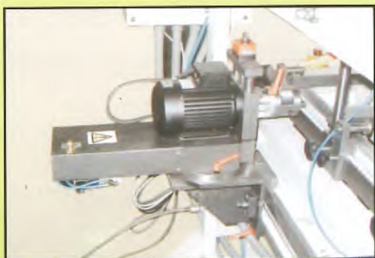
Jednostka wiertarska skrętna JS z głowicą 3 wrzecionową okrągłą
