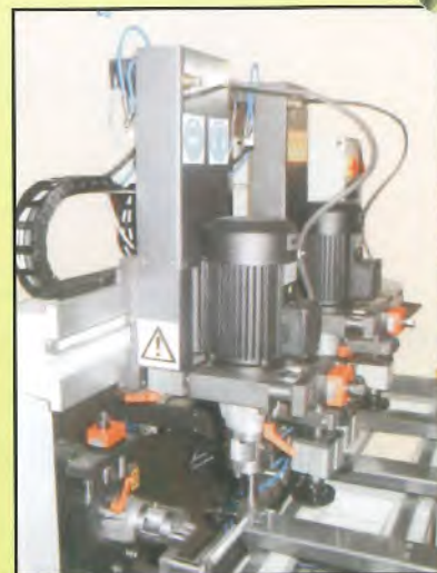
Jednostki górne JG z głowicami liniowymi i głowicami pod zawiasy puszkowe
