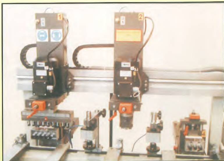
Jednostki górne JG z głowicami liniowymi i głowicami pod zawiasy puszkowe
