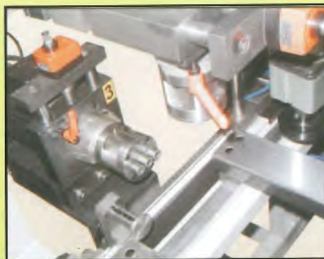
Jednostka wiertarska skrętna JS z głowicą 3 wrzecionową okrągłą
