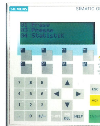
Modernste Steuerungstechnik OP7, Diagnosesystem und Betriebsdatenerfassung, optional Modemanschluß für Telefonservice
