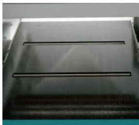
Option PS 43/53/63 N° 2 rulli sul piano N° 2 rouleaux sur la table N° 2 rodillos sobre la mesa
