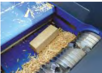
Rotor mit einer Messerreihe für geringe Leistungsaufnahme
