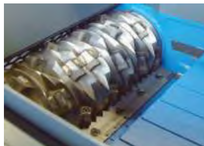
Rotor mit 368 Durchmesser mit zwei Messerreihen für höheren Durchsatz
