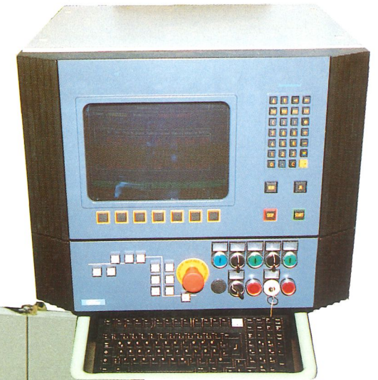
Freiprogrammierbare PC-Steuerung zur zentralen Bedienung der Anlage. Online-Anschluß möglich.
