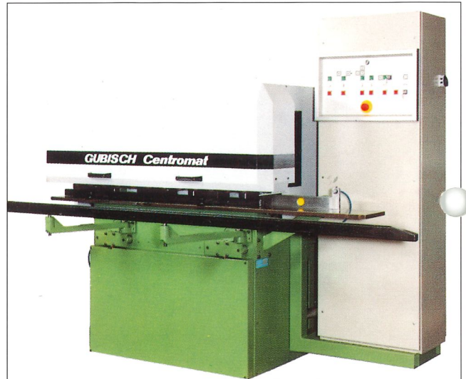
- Ablängsäge automatisch von oben eintauchend - pneum. Horizontalverstellung - Revolveranschlag für 12 Positionen
