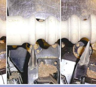
Nos machines combinent les solutions éprouvées gagnées dans 35 ans de construction de tours à bois avec la nouvelle technique innovatrice, comme par exemple le ciseau tournant pivotable. Celui-ci permet une coupe de contour dans les deux directions, dans un seul pas de travail continu sans changement d'outil.
