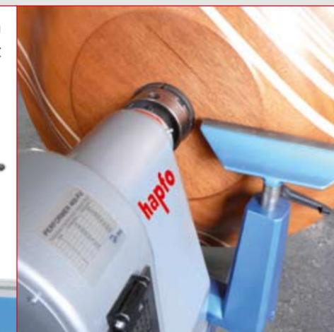
Schlankes Spindelkastengehäuse ermöglicht auch rückseitiges Arbeiten
