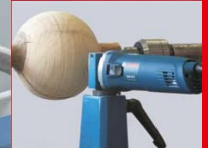
Werkzeughalterung mit 43mm Bohrung zum alternativen Einsatz einer Oberfräse (nicht im Lieferumfang)
