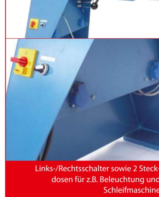
Links-/Rechtsschalter sowie 2 Steckdosen für z.B. Beleuchtung und Schleifmaschine
