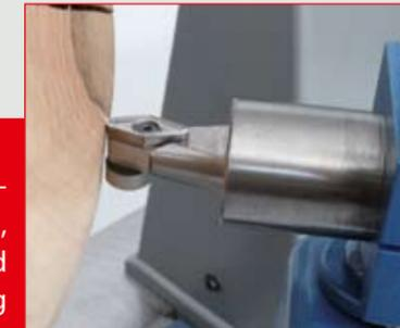
Werkzeughalter mit Hartmetall-Wendeplatte zum Schruppen, dadurch kaum Verschleiss und kein Nachschleifen notwendig
