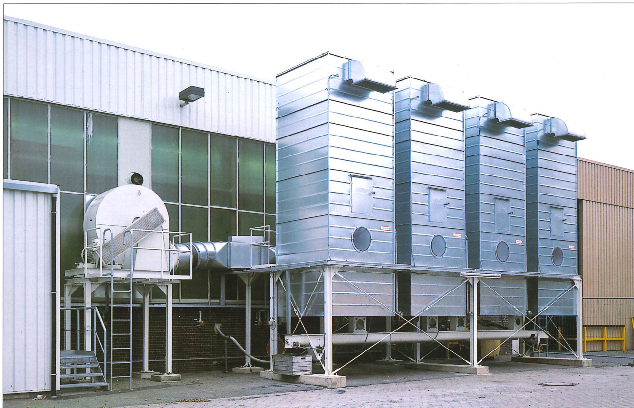
Instalacja z filtrami ze zbiornikami pośrednimi dla zabudowy pojedynczej lub szeregowej przy pracy ciągłej.
