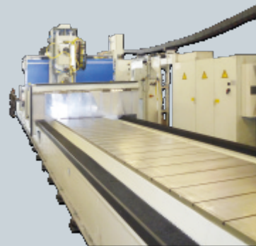
Bearbeitungszentrum für Keramikleisten Machining center for ceramic-strips
