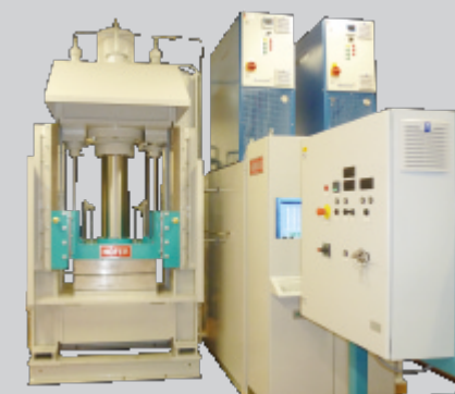
Thermoöl temperierte Präzisionslaborpresse Heat transfer oil tempered precision laboratory press
