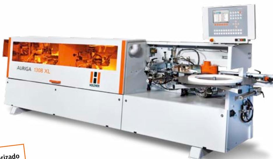
Opcional con ajuste motorizado del puente prensor
