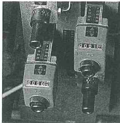
Digital-(Siko)-Zählwerke Kappaggregat 1915, Fräsaggregate 1920, 1937, 1962, 1966, Schleifaggregat 1935, Ziehklängenaggregat 1927 und Schwabbelaggregat 1941 und 1944
