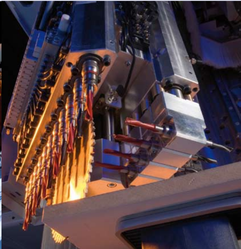
Diferentes cabezales de taladrado de alta velocidad con sierra integrada y con husillo de fresado que, de forma exclusiva, puede pivotar 360°
