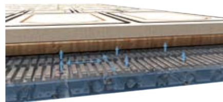
Función de colchon de aire que facilita la manipulación de piezas de gran formato
