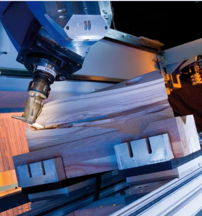
Drive5+: Opcionalmente husillos de fresado en 3, 4 ó 5 ejes con acceso a un total de hasta 72 herramientas y grupos
