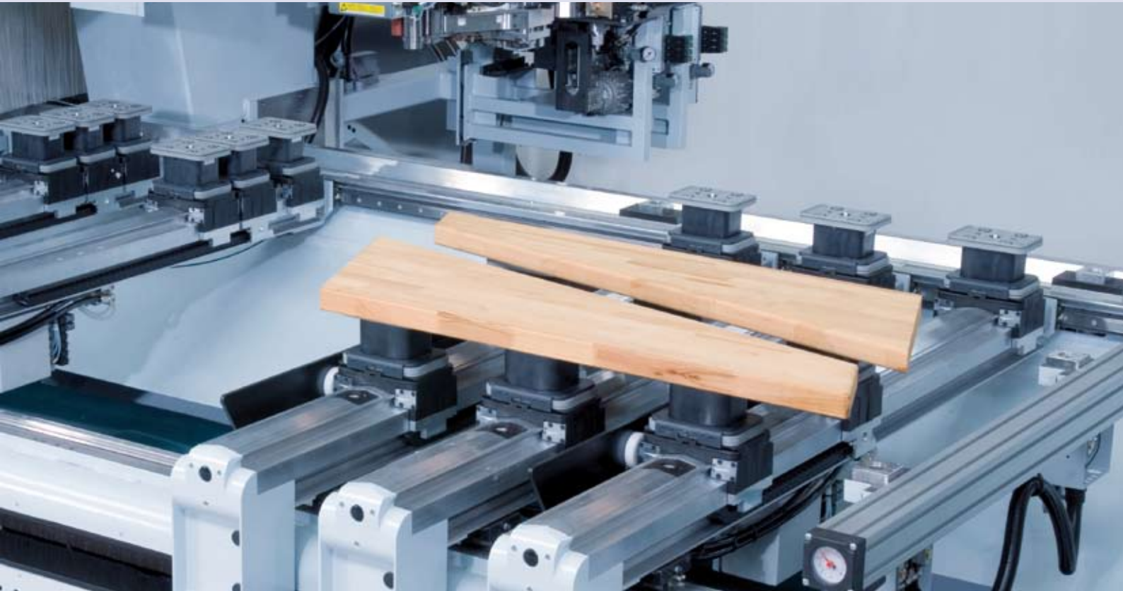
Desplazamiento de los peldaños tras su seccionado para el mecanizado completo.
