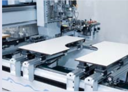
Desplazamiento lateral de las consolas tras el seccionado de los tableros brutos para el aplacado de cantos
