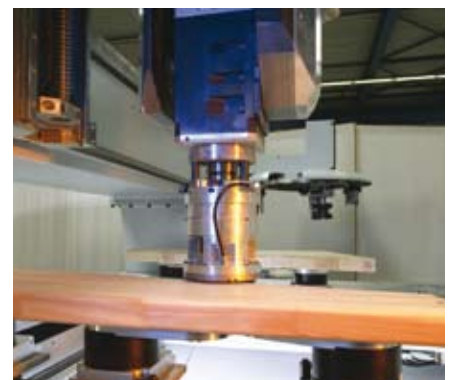
DRIVE5+: husillo de fresado con grupo con palpación vertical
