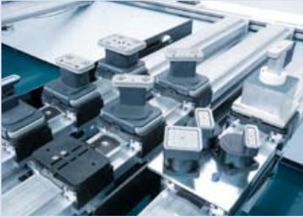
Los distintos elementos de amarre por vacío y neumáticos garantizan un mecanizado exacto de distintas piezas y materiales
