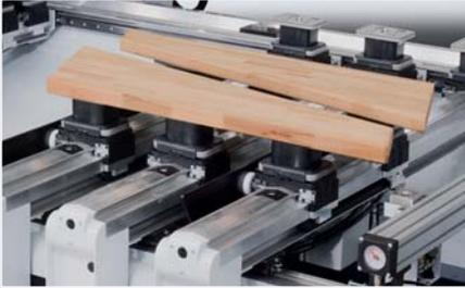
Automatisches Auftrennen und Auseinanderfahren von Treppenstufen für die umlaufende Komplettbearbeitung
