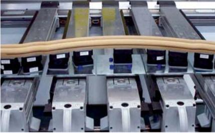
Durch das Maxi-Flex-Spannsystem entsteht eine durchgängige Ebene zur beliebigen Spannmittelpositionierung
