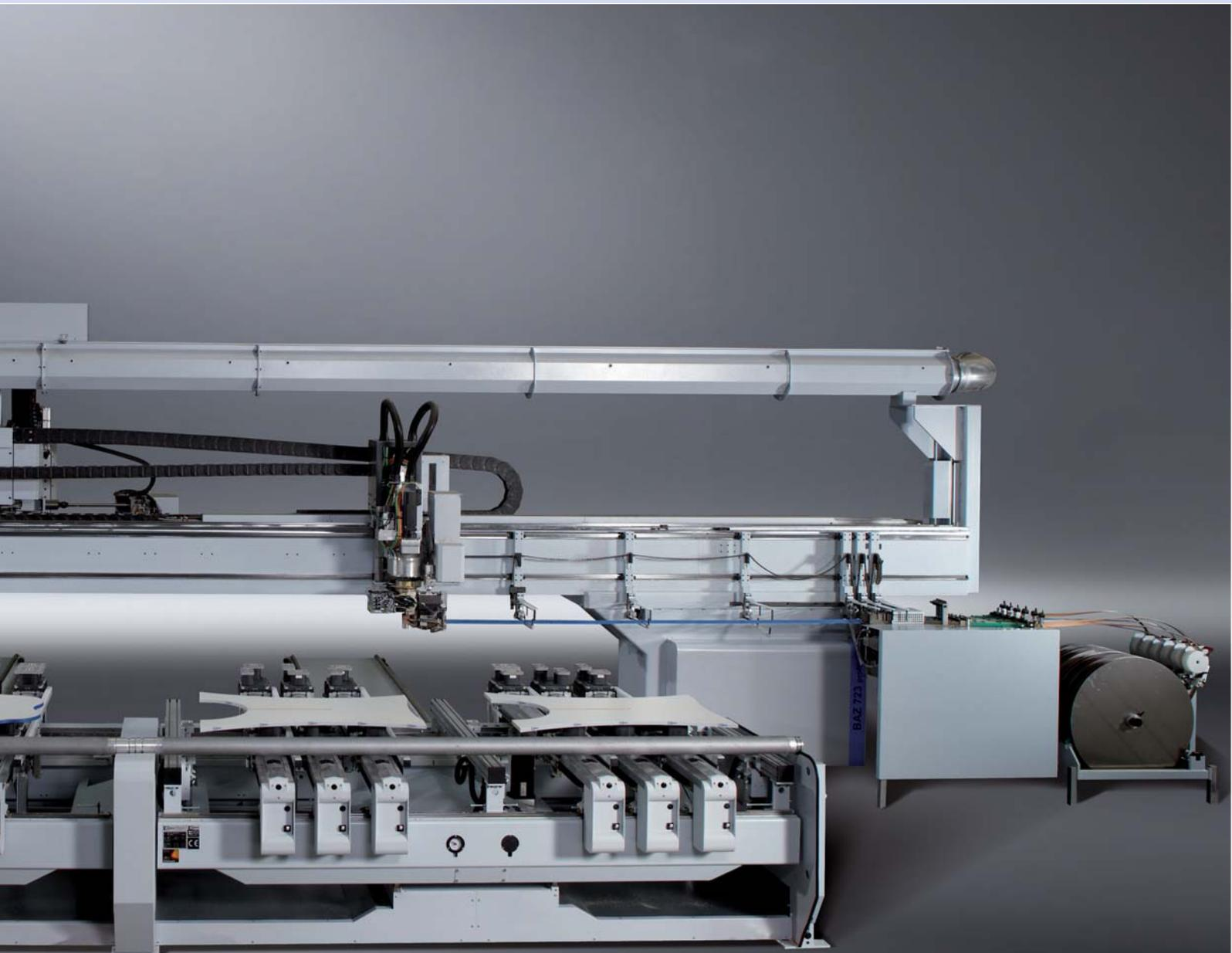
Unterschiedliche Tischsysteme zum flexiblen und sicheren Fixieren unterschiedlicher Werkstücke. Je nach Werkstückgeometrien und Oberflächenbeschaffenheit der Werkstücke kann wahlweise mittels Vakuum, Pneumatik und mechanischen Spannmitteln fixiert werden.
