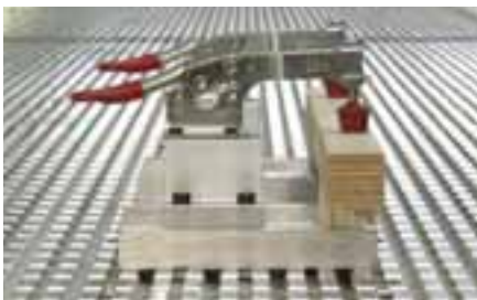
La mesa MATRIX de aluminio ranurada garantiza la inmovilización con precisión de las piezas gracias a unos elementos de sujeción mecánicos en un punto cualquiera
