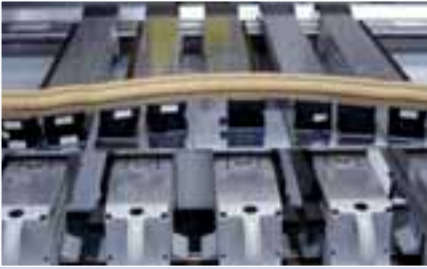
El sistema de sujeción Maxi-Flex hace posible crear un plano continuo que permite un libre posicionamiento de los dispositivos de sujeción
