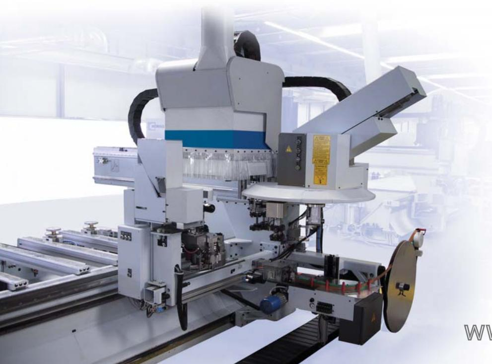
Für eine flexible Fertigung stehen mitfahrende Kantenmagazine für 1, 2 oder 6 Rollen zur Verfügung.
