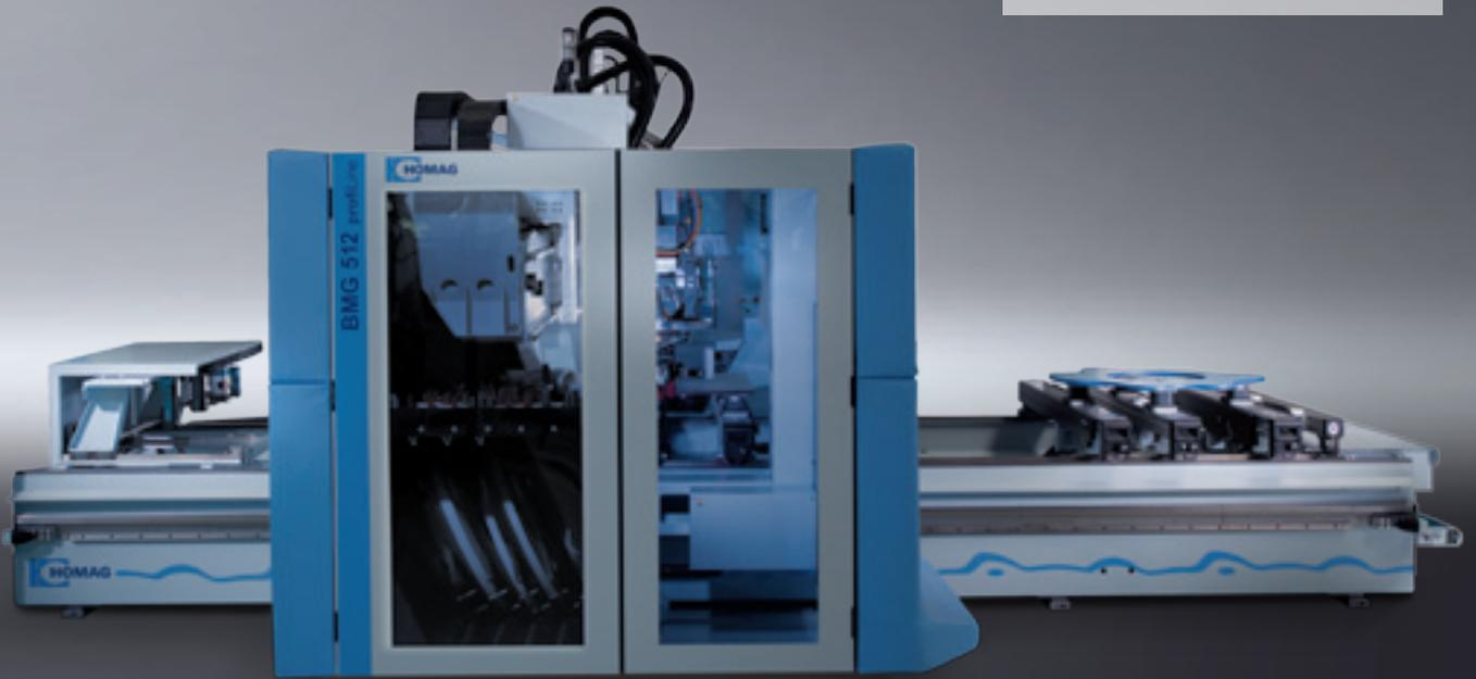
**BMG511/R** : centre d'usinage avec table rainurée en aluminium pour l'usinage de pièces techniques, pièces de forme et Nesting
