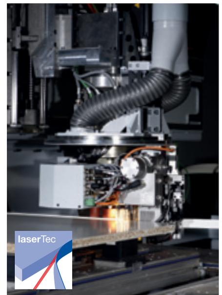
Un trait laser fait fondre la surface à encoller qui est directement pressée sur la pièce. Le résultat: des chants de haute qualité, pas de transition entre le panneau et le chant (joint zéro), une adhérence et une résistance à la chaleur et à l'humidité élevées.
