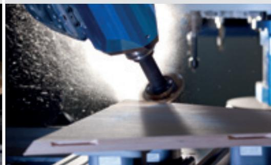
Fraisage de rainures en biais pour un assemblage de panneaux
