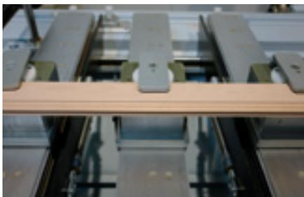
Élément de serrage multiple pour système de dépression à deux circuits
