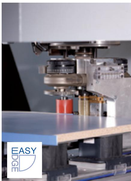
L'agrégat **easyEdge** est logé directement de la station pick-up dans le changeur linéaire latéral, alimentez le chant, et c'est parti. L'agrégat peut être utilisé avec toutes les broches 4 et 5 axes.
