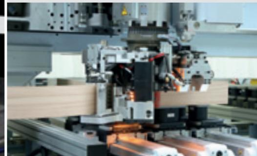
Encollage de chants pour des pièces d'une hauteur allant jusqu'à 100mm
