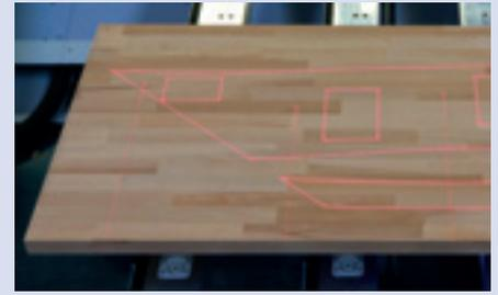
Projection laser des éléments de serrage et du contour des pièces pour une utilisation optimale et une dépose simple des pièces brutes qui ne peuvent pas être alignées contre les butées.
