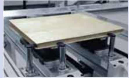
Sistema de sujeción flexible: Topes pivotantes para piezas con con rechapados salientes (opción)
