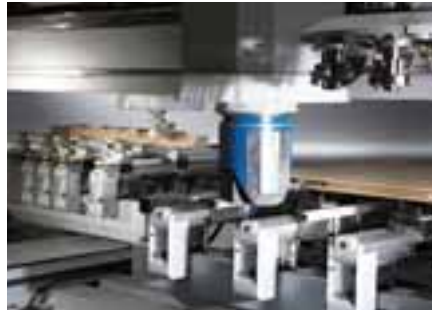
Mecanizado simultáneo de un cerco de puerta y de una hoja de puerta
