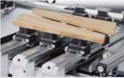
Seccionado y separación automática de peldaños de escalera para hacer posible un mecanizado perimetral completo
