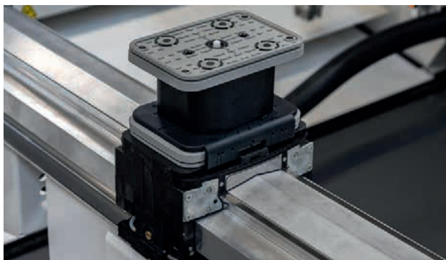
Vakuumspanner mit Tastventil – nicht belegte Sauger können auf der Plattform bleiben. Aufbauhöhe 100 mm
