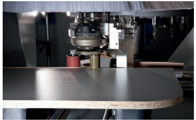
Verleimaggregat easyEdge zum rationellen Anleimen an Formteile
