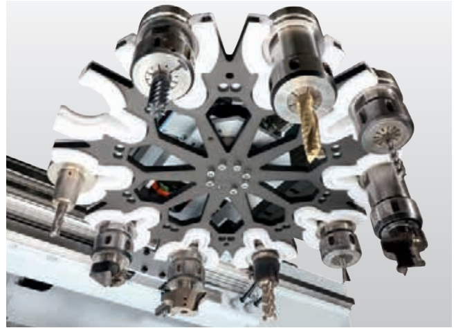
10-fach Tellerwechsler an der Spindel mitfahrend. Werkzeugwechsel während des Bohrens oder Kantenanleimens. Für Werkzeuge und Aggregate mit einem Durchmesser von bis zu 180 mm.
