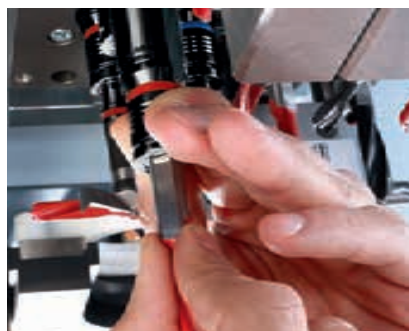
Patentiertes Schnellwechselsystem für einen Bohrerwechsel ohne Werkzeuge zur Reduzierung der Rüstzeiten.
