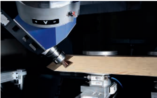
Fräsen einer Gratverbindung für Pfosten-/Riegelkonstruktionen
