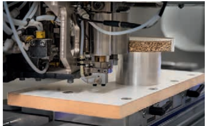
360° Kantenverleimung mit dem powerEdge Pro Duo Kantenanleimaggregat
