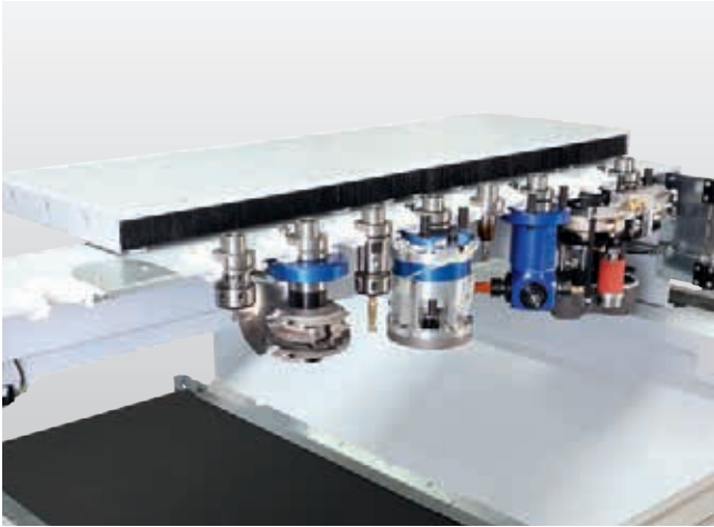
8-fach Linearwechsler mit Werkzeugübergabeplatz, seitlich angebaut. Optional ist auch der Pick-up-Platz für das easyEdge-Aggregat integriert.
