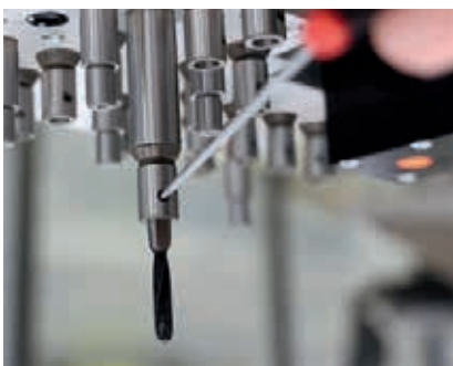
Weldon Wechselsystem für einen Bohrerwechsel mit Werkzeugen
