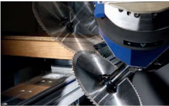
Exakte und ausrissfreie Gehrungsschnitte
