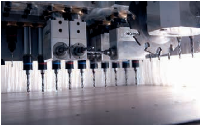
High-Speed-Bohrtechnik mit Nutsäge
