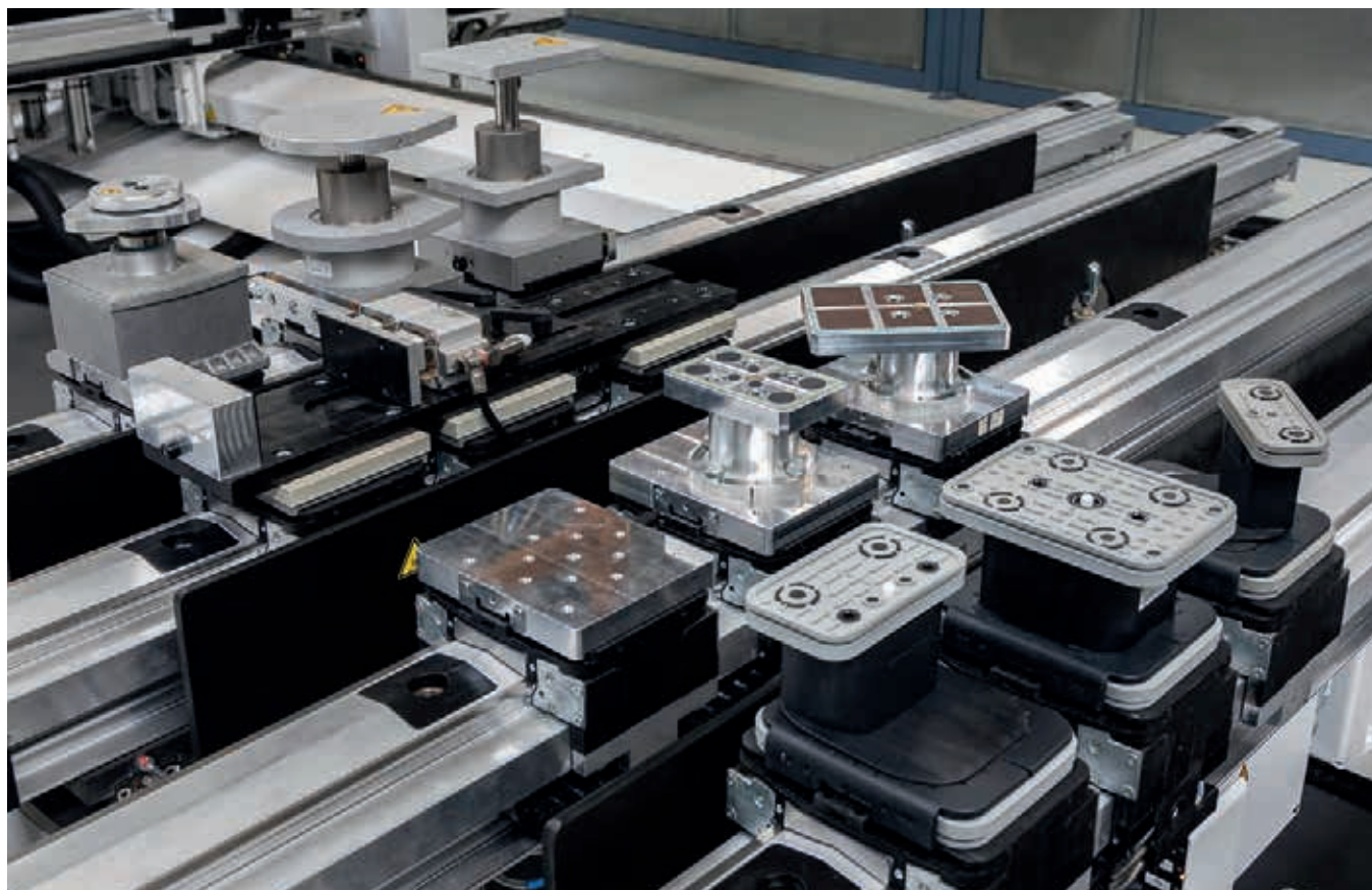
Vakuumspanner mit Tastventil – nicht belegte Sauger können auf der Plattform bleiben. Aufbauhöhe 100 mm
