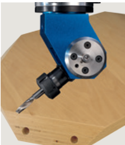
Bohren/Fräsen schwenkbar gekröpft (0° - 90°)
