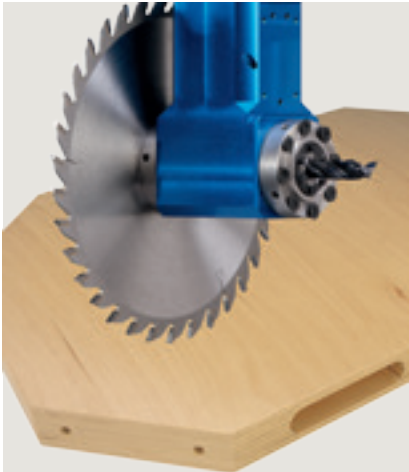
Bohren/Fräsen/Sägen 2 Spindeln (auch als HIGH PERFORMANCE Aggregat)
