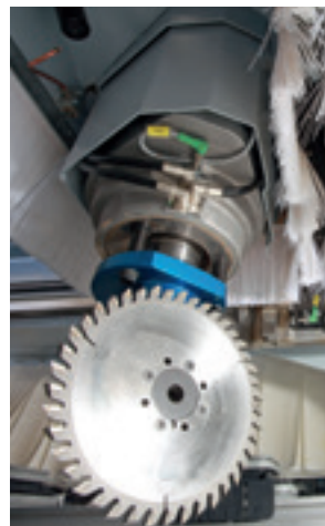
C-Achse (0-360°) für den Einsatz von Aggregaten
