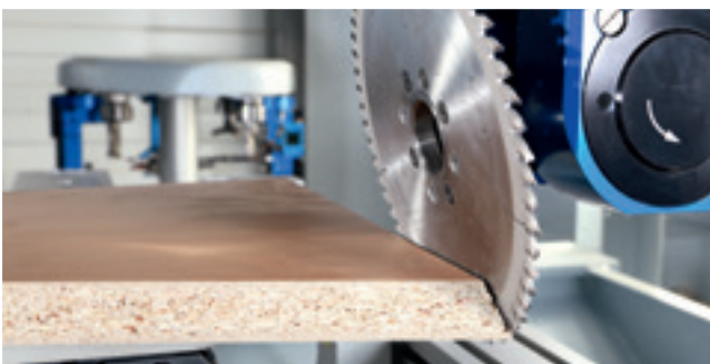
Serrado de los cortes en ángulo
