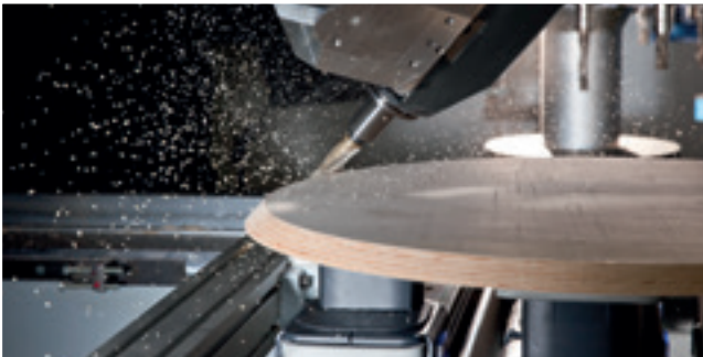
Fresado del bisel en una placa de la mesa
