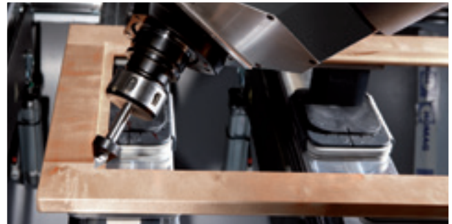
Recorte en ángulo de una esquina para rebajo de vidrio
