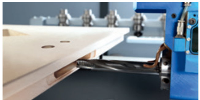
Fresado de la caja de cerradura
