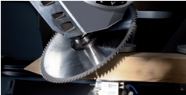
Corte compuesto con gran profundidad de corte para piezas de marcos
