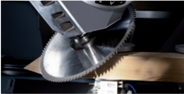
Coupe en biais de grande profondeur pour pièces de cadres
