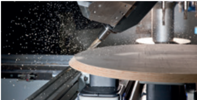
Fraisage de feuillure sur un plan de table
