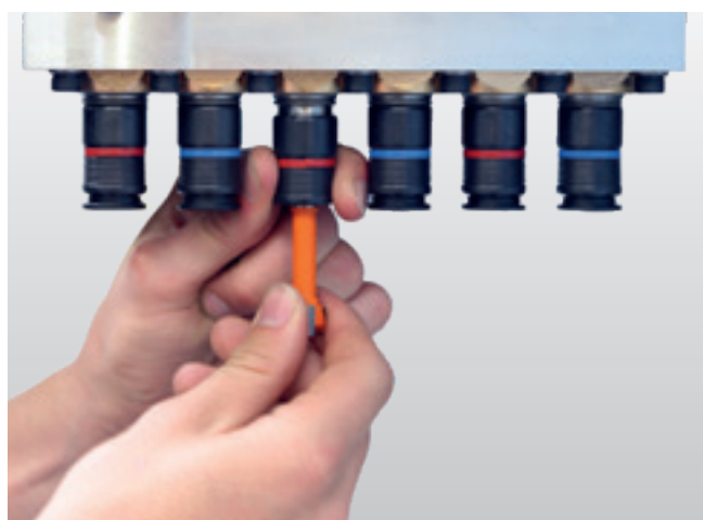
Запатентованная система быстрой смены сверла без инструмента для сокращения времени установки.
