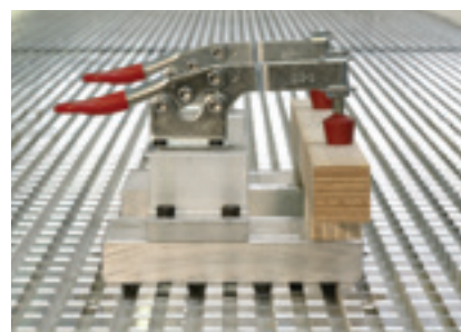
Крепеж с использованием нестандартных зажимов Алюминиевый матричный стол с пазами типа «ласточкин хвост» гарантирует точную и надежную фиксацию зажимного элемента.
