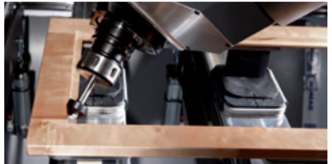
Обработка внутреннего прямого угла оконной створки
