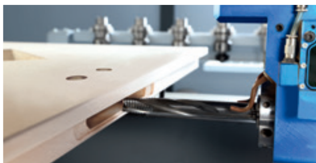
Фрезерование гнезда под замок
