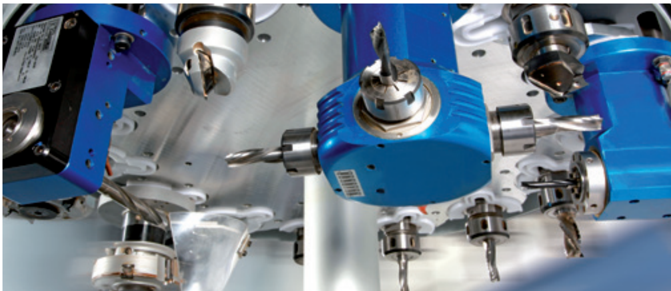
Магазин смены инструмента на 8 позиций. Совместное движение в X-направлении.
