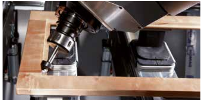
Eckiges Ausspitzen einer Glasfalz-Ecke
