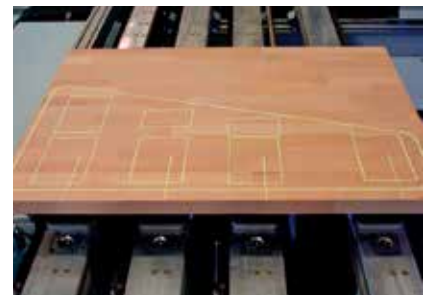
Laserprojektion der Spannmittel und der Werkstückkontur für optimale Ausnutzung und einfaches Auflegen von Rohteilen, die nicht an den Anschlägen ausgerichtet werden können.
