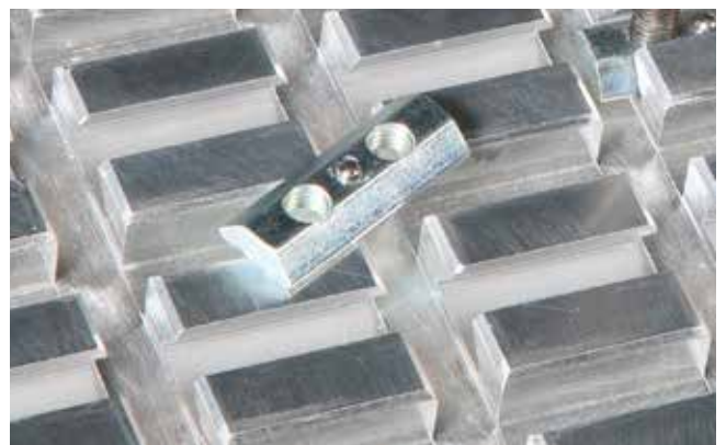
Nutensteine mit Gewinde zur formschlüssigen Fixierung von Spannvorrichtungen in der Schwalbenschanzführung
