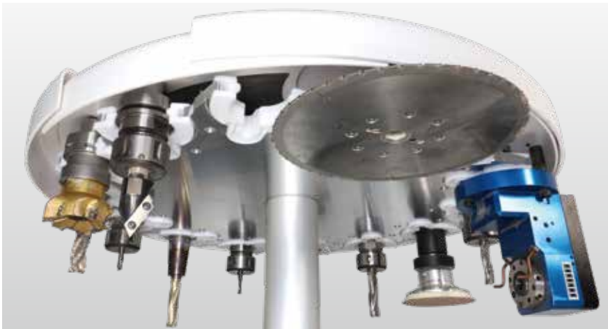
14-fach Tellerwechsler in X-Richtung, mitfahrend. Auch für Sägeblätter mit einem Durchmesser bis zu 300 mm.
