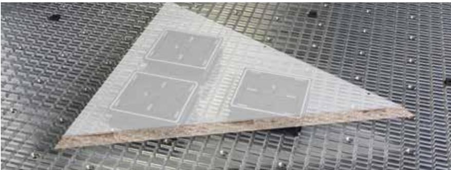
**Fijadores de vacío:** elementos de sujeción de vacío para instalar en las ranuras de la mesa tramada
