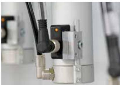
**Consulta electrónica de posición final:** aumento de la seguridad mediante una consulta electrónica de posición final en todos los cilindros de tope disponibles
