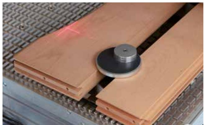
**Posicionamiento del láser:** el láser de mira en cruz permite recorrer el contorno de fresado
