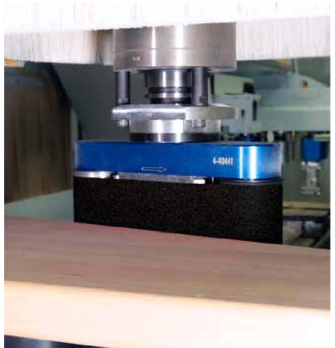
**El inteligente cabezal de 5 ejes DRIVE5CS** tiene un diseño más compacto con trayectorias de fuerza cortas. Mucha tecnología en un espacio pequeño sin limitaciones en la gama de mecanizados. Husillos refrigerados por líquido con una potencia de fresado de 10 kW (12 kW opcionales) para trabajos exigentes. El reducido diseño ofrece más espacio para mecanizar (por ejemplo, con una hoja de sierra de 350 mm debajo de la capota).
