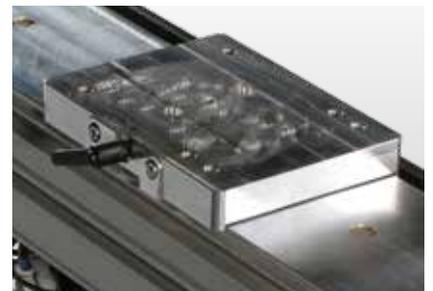
**Módulo de la placa base** para colocarse en la consola como base para los dispositivos de sujeción especiales
