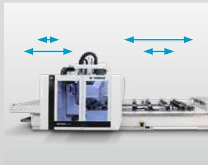
**Modo pendular dinámico** sin divisiones de campos fijas. De esta manera, aunque haya piezas alargadas en uno de los lados de la máquina, se podrá colocar una pieza corta en el otro lado.
