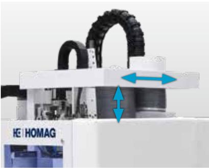
**Aspiración eficaz** con baja potencia de conexión gracias a la optimización de la detección y dispersión de virutas. La capota se puede ajustar de manera continua con un motor.
