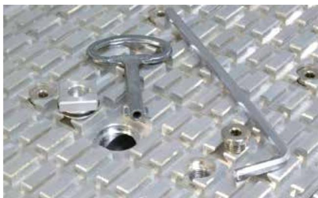
**Conexiones de vacío de 1" con apertura rápida** mediante la llave del armario de distribución y aperturas de vacío con rosca fina para asegurar los medios de fijación
