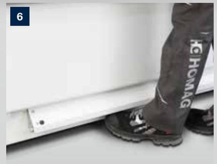
**Regleta de conmutación en lugar de interruptores de pedal.** No es necesario buscar ni desplazar el interruptor de pedal: los topes, los rieles de separación y la sujeción al vacío se pueden activar fácilmente.
