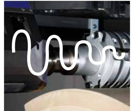
**Refrigeración por líquido y sensor del husillo (opcional para DRIVE5CS):** los husillos de fresado refrigerados por líquido con almacenamiento híbrido ofrecen una gran vida útil. El sensor de oscilación adicional detecta los desequilibrios de las herramientas y protege a los husillos de la sobrecarga provocada, por ejemplo, por los avances elevados.
