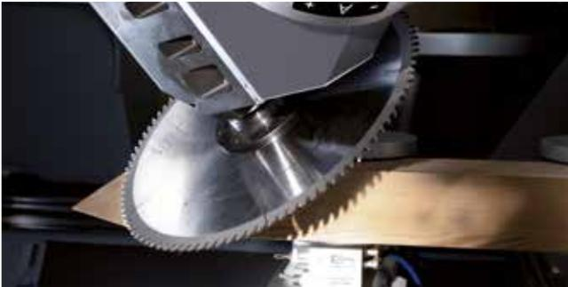
Corte especial con una gran profundidad de corte para las partes del bastidor
