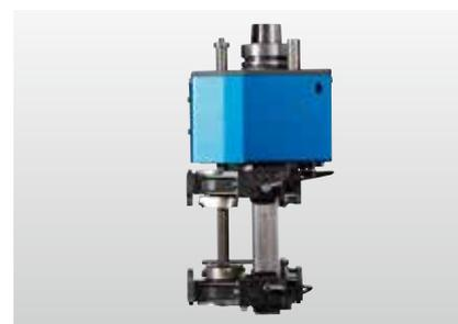
**Grupo combinado de fresado a ras y raspado** para fresar a ras el perfil de canto y realizar su mecanizado posterior con la cuchilla rascadora. El sistema de exploración de tres lados del grupo compensa las tolerancias de las piezas y los cantos, y garantiza una elevada calidad de mecanizado (herramientas incluidas).
