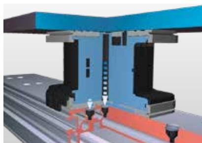
**Sistema de vacío de doble circuito:** tecnología de sujeción al vacío exclusiva con doble falda obturadora para el desplazamiento continuo de los tensores a lo largo de la consola. El primer circuito de sujeción fija el tensor a la consola y evita cualquier desplazamiento no deseado, mientras que el segundo mantiene el material en su posición.
