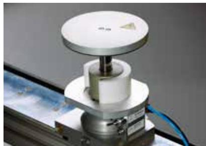
**PowerClamp:** por ejemplo, para el mecanizado de 6 lados de componentes de madera maciza (placa base con ajuste de altura)
