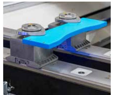
**Multitensor** para el sistema de vacío de doble circuito. Elemento de sujeción por vacío para sujetar listones y piezas individuales de la ventana.
