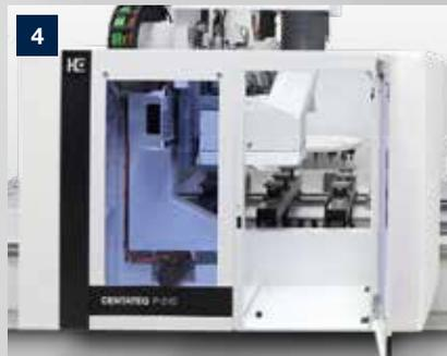
**Máxima visibilidad** en la máquina y, al mismo tiempo, protección óptima para el operario gracias a la gran ventana de control. Puede llevar a cabo el cambio de broca y el servicio en la parte delantera de la máquina de forma cómoda.
