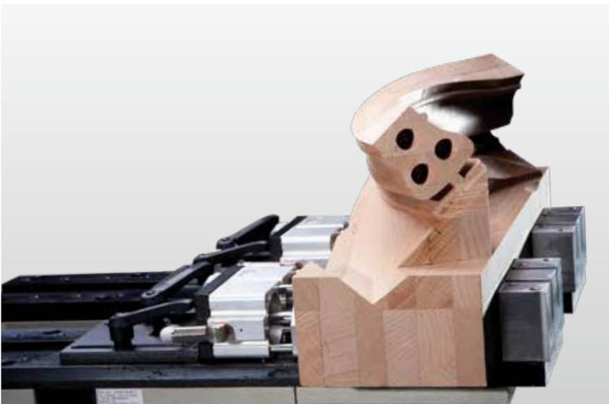
**El dispositivo de apriete** ofrece una sujeción rápida y segura de postes y piezas individuales de la ventana.
