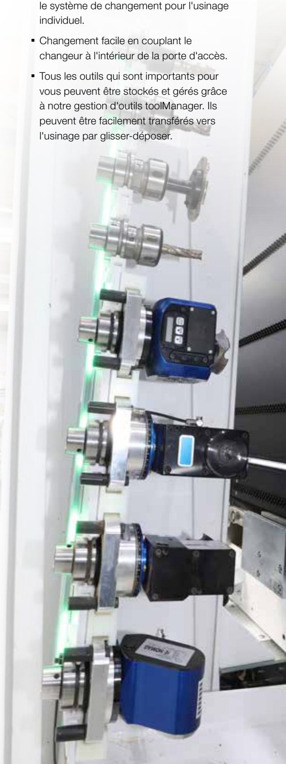
Agrégat de sciage/fraisage et agrégat de perçage, double
