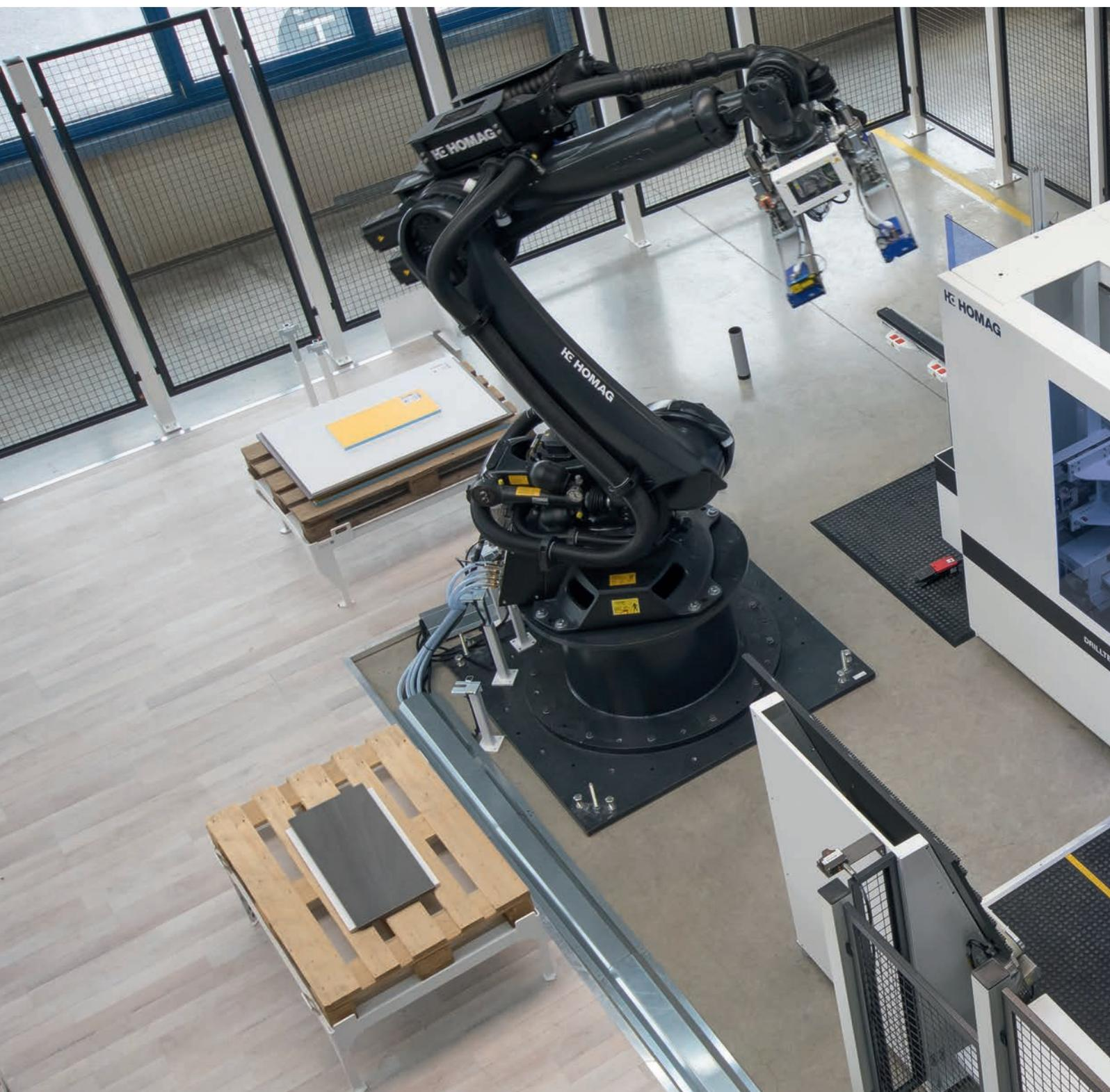
Ein CNC-Bearbeitungszentrum mit Roboterunterstützung bildet eine der kleinsten möglichen Zellen im Rahmen der Möbelproduktion. In dieser Kombination erhöht der FEEDBOT Ihre Gesamtproduktivität. Er muss nicht pausieren, kann rund um die Uhr in der Werkstatt arbeiten und eine gleichbleibend hohe Qualität gewährleisten. Kleine und mittelständische Unternehmen sparen durch den Einsatz des FEEDBOT D-300
