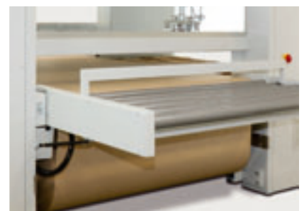
Vakuumtransport mit zusätzlicher Papierauflage. Einweg-Papier macht aufwendiges Transportreinigungssystem sowie das Reinigen der Maschine bei Chargenwechsel überflüssig.
