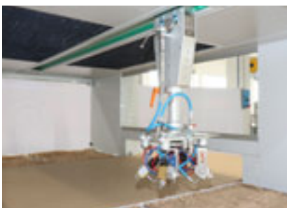
Schlittenläufer mit einem Spritzarm für vier Spritzpistolen.
