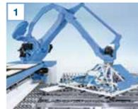
**Roboter mit Saugtraverse**
