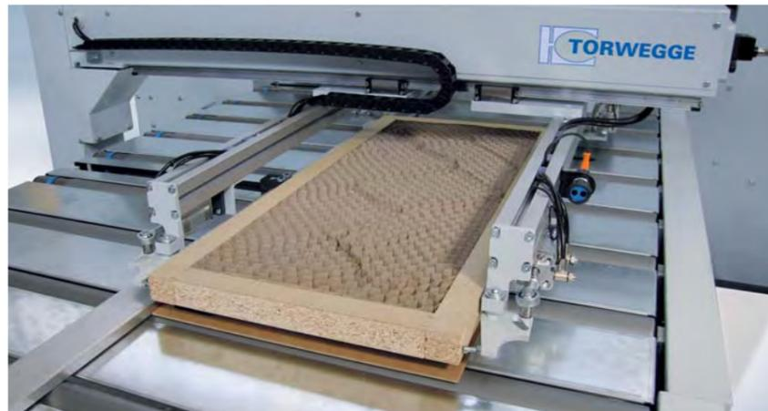
TORWEGGE PWR 500 – Anlage zur Verbund- und Leichtbauplattenherstellung
