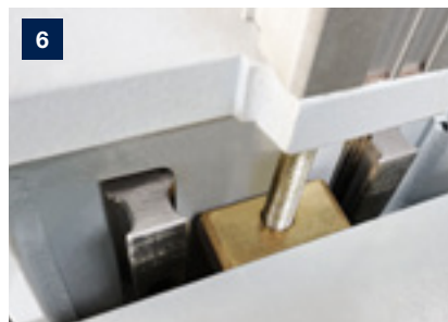
6 Guides linéaires pour une adaptation dynamique au diamètre d'outil des broches supérieures pour une qualité de surface optimale
