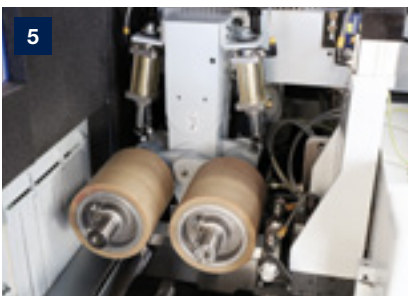
5 Rouleaux de pression supérieurs entraînés caoutchoutés après l'usinage supérieur (dureté Shore : 80)
