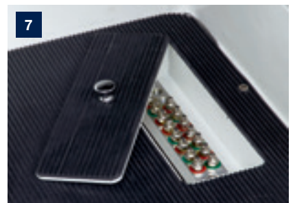
7 Graissage centralisé accessible sur le côté avant de la machine
