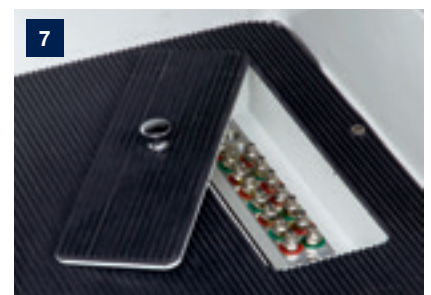
Toegankelijke centrale smering aan de voorzijde van de machine
