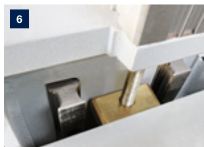
Lineaire geleidingen voor een dynamische aanpassing aan de gereedschapsdiameter van de bovenste spindel voor optimale oppervlaktekwaliteit
