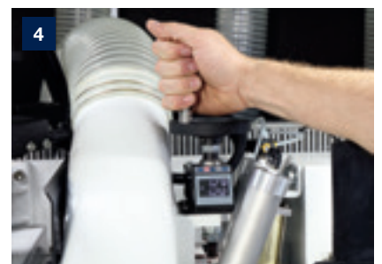
Radiale verstelling van de drukelementen door middel van elektrische weergave, voor automatische weergave en terugkoppeling van de vergelijking tussen instelwaarde en werkelijke waarde plus de correctiefactor
