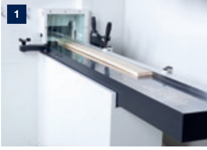
Manuel olarak ayarlanabilen Krom Kaplı Makine Giriş Tablası
