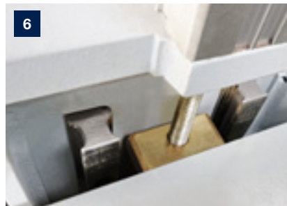
Optimum yüzey kalitesi elde edebilmek için üst millerin lineer klavuzlar yardımıyla...
