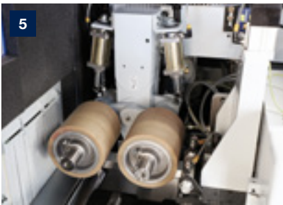
İş parçası son üst milden geçtikten sonra malzeme yüzey kalitesini korumak için Kauçuk Üst Baskı Merdaneleri
