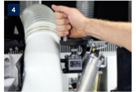
Baskı pabucunun dijital gössterge yardımıyla radyal ayarı !! Makinenin hızlı ayarını sağlar
