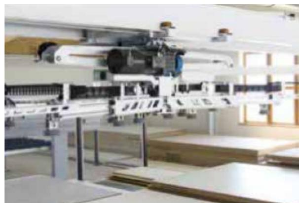
Die **Saugtraverse ST71** in X-Geometrie ist die ideale Zusatzausstattung für das STORETEQ S-200. Die selbstlernende Traverse generiert die für das Plattenhandling benötigten Daten eigenständig und sorgt so für zuverlässige Prozesssicherheit. Eingaben durch einen Bediener sind nicht notwendig.
