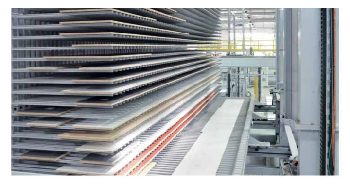
Optimale Platzausnutzung dank der idealen Positionierung des Materials: Die Bauteile werden bereits im Aufnahmebereich ideal positioniert, um eine optimale Ausnutzung der Regalfächer zu sichern.
