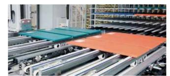
Hohe Lagerkapazität dank idealer Positionierung des Materials schon im Aufnahmebereich: Bereits bei der Entnahme der Teile vom Transportband wird das Material genau positioniert, um die Regalfächer ideal zu füllen.
