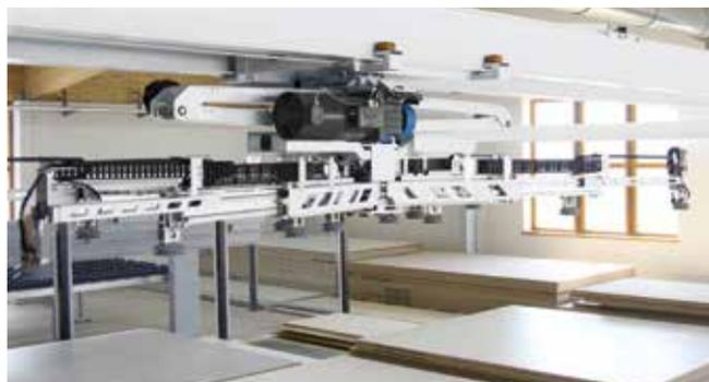
A **travessa de aspiração ST71** em forma de X é o acessório ideal para o STORETEQ S-200. No quesito segurança do processo, a travessa com função de autoaprendizagem não deixa nada a desejar. A própria ST71 gera os dados necessários para o manuseio das placas, dispensando assim as entradas por parte de um operador.
