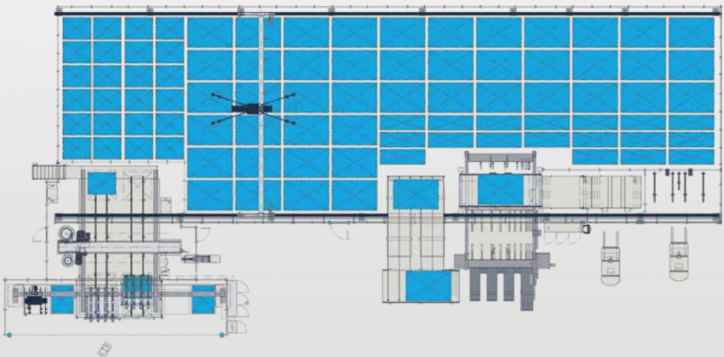
**4 Gerenciador de estoque com seccionadora e máquina CNC com mais de 30 posições de pilhas**
