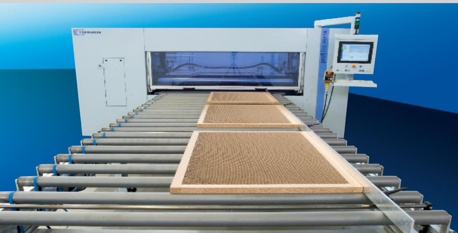
PWR 500 con aplicación de cola por una cara, modelo de 1.600 mm de anchura
