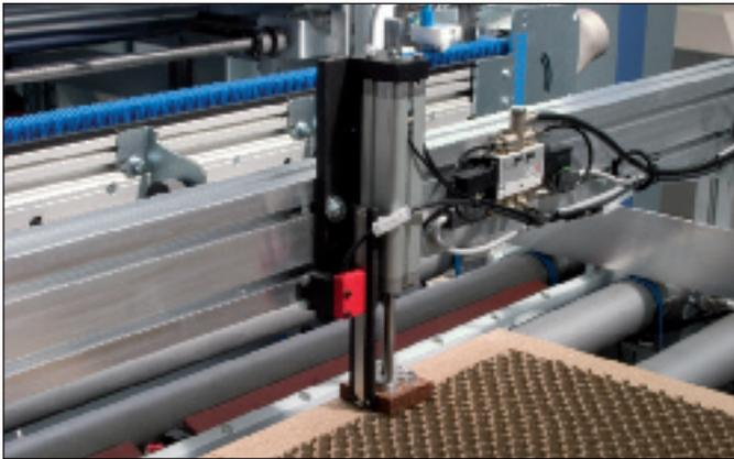
Sistema electrónico de medición de espesores
