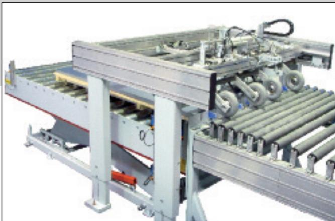
Carga de tableros de espesor reducido
