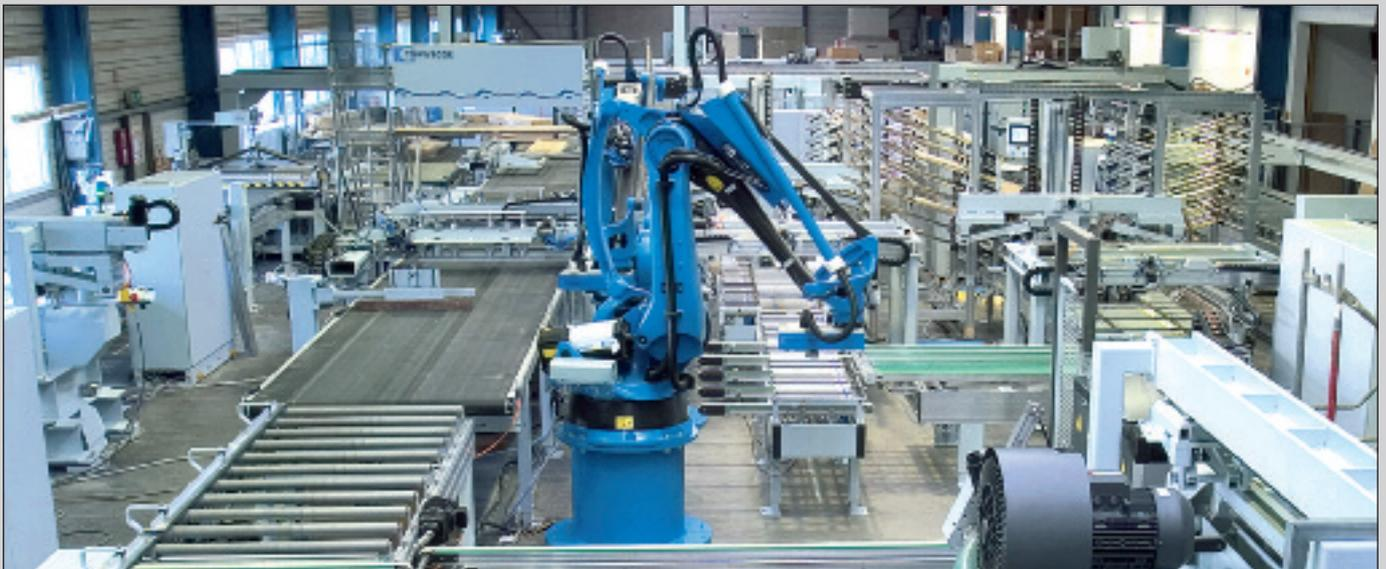
Línea para paneles ligeros con almacén automático de listones y estación de carga automática de marcos
