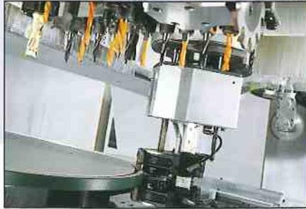
Erstklassige Ergebnisse – für bestechende Kantentoptik sorgt das getastete Kombi-Bündigräs-Nachputzaggregat, das den Antrieb, die C-Achse sowie die Pneumatik verwendet. Auch hier handelt es sich um patentierte HOMAG Technik
