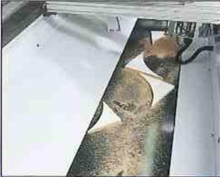
Hochsteifes Maschinenbett mit integrierter Reststückentsorgung über die gesamte Bearbeitungstiefe von 1.300 (Venture 20) bzw. 1.600 mm (Venure 22). Es fallen keine Reststücke vor die Maschine (optional mit Späntransportband)
