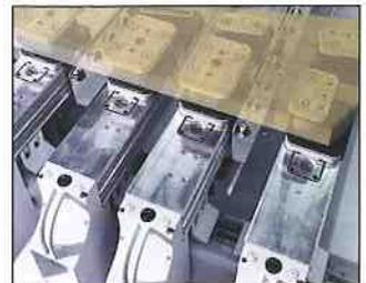
Arbeitstisch mit sechs Konsolen und präzisen Linearführungen zur optimalen Werkstückspannung bei schwerer Zerspaltung
