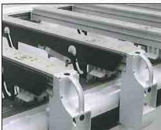
Robuste Einlegehilfen zur Auflage schwerer Werkstücke
