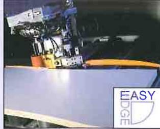
Die patentierte Elektronikchnittstelle ermöglicht den Einsatz der einwechselbaren Kantenanleimaggregate EasyEdge und PowerEdge für das perfekte Anleimen von Kanten an Formteile. Erstklassiges Kantenfinish mittels Nachbearbeitungsaggregaten. HOMAG – 1.000-fache Erfahrung zu Ihrem Nutzen
