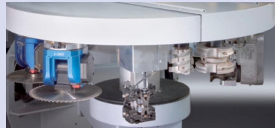
Werkzeugwechsler bieten die Grundlage für den flexiblen Einsatz von Werkzeugen und Aggregaten, auch mit großen Durchmessern von bis zu 200 mm.
