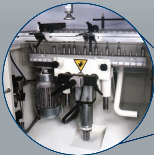
Zylinderrundstangenführung des Bohraggregats
