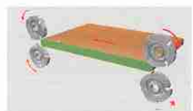
Gruppo arrotondatore 4 motori 4 motor corner rounding unit Grupo redondeador 4 motores
